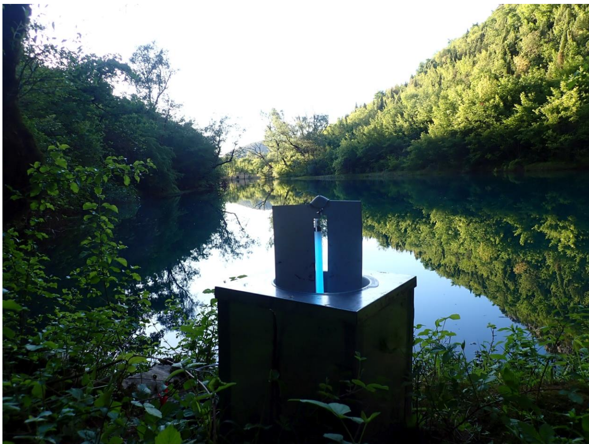
Slika 3. Svjetlosna zamka za prikupljanje podataka o fauni noćnih leptirana izvoru rijeke Bunice.
